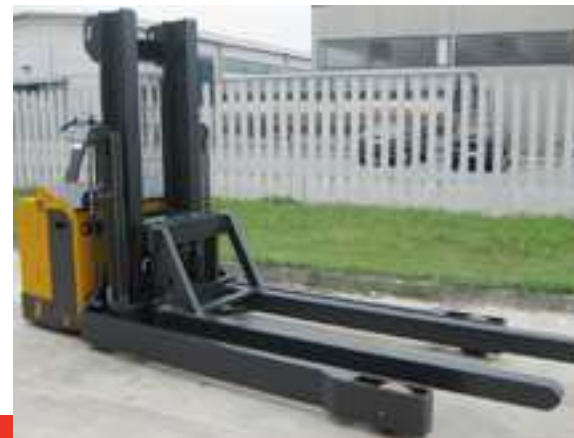
3 - Deichselstapler SBP XT TAV Tragfähigkeit 3.000 kg
