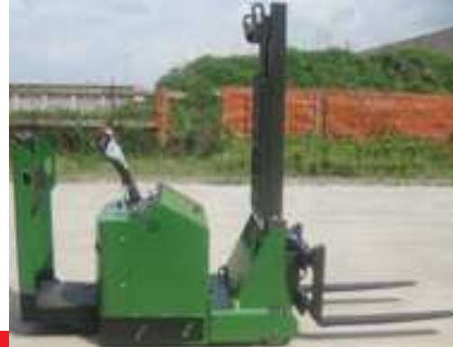
1 - Gegengewichtsstapler SBC XT Tragfähigkeit 1.200 kg
