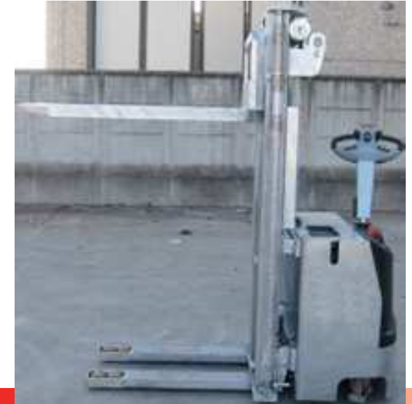
2 - Deichselstapler verzinkt SBM Tragfähigkeit 1.200 kg
