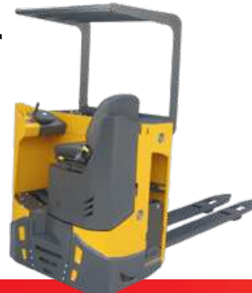
1 - Elektrohubwagen K9 SOB XT Tragfähigkeit 3.000 kg
