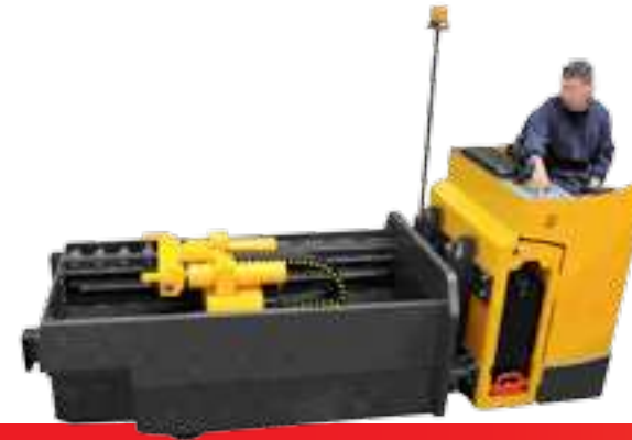
1 - Elektrohubwagen K9 SOB XT Tragfähigkeit 4.000 kg
