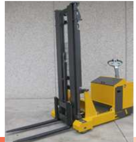
6 - Gegengewichtsstapler SBC XT Tragfähigkeit 2.000 kg
