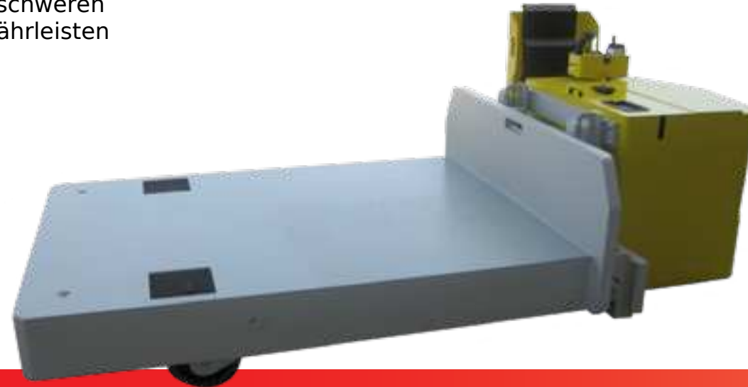
3 - Elektrohubwagen K9 SBM XT P Tragfähigkeit 10.000 kg
