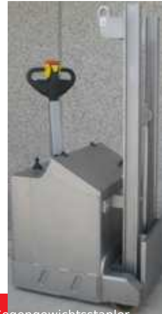
1 - Gegengewichtsstapler SBC C Tragfähigkeit 600 kg
