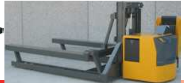
2 - Flughafen Transporter Atlas Tragfähigkeit 7.000 kg
