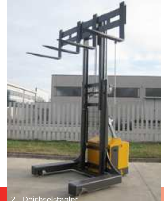
2 - Deichselstapler SBP XT Tragfähigkeit 2.000 kg
