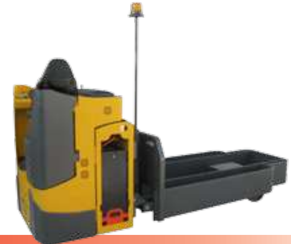
5 - Elektrohubwagen K9 SOB XT Tragfähigkeit 4.000 kg
