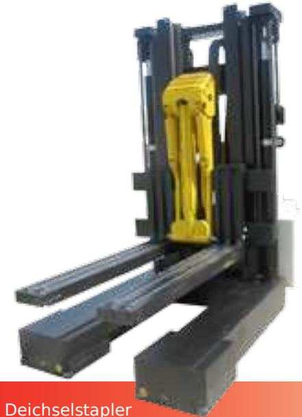
2 - Deichselstapler SBP XT Tragfähigkeit 8.000 kg
