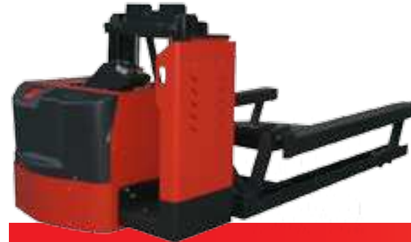
1 - Flughafen Transporter Atlas Tragfähigkeit 6.000 kg
