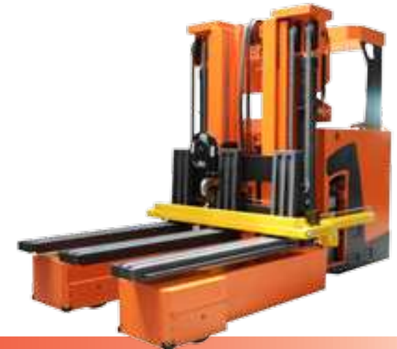
4 - Deichselstapler SOB XT Tragfähigkeit 12.000 kg
