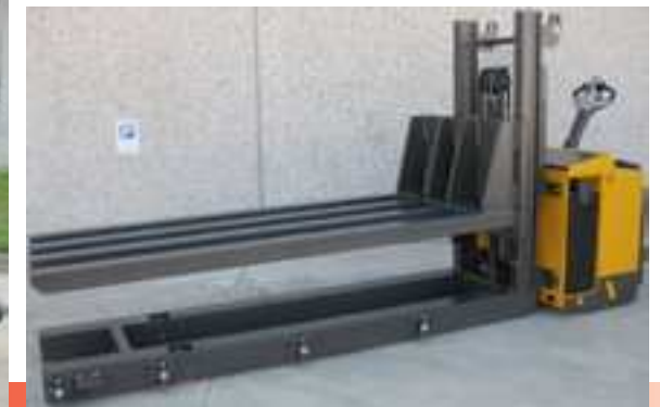
4 - Deichselstapler SBP XT TAV Tragfähigkeit 4.000 kg
